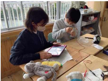
理科「電気とわたしたちの暮らし」 手回し発電機を使って、コンデンサーに電気をためています。
